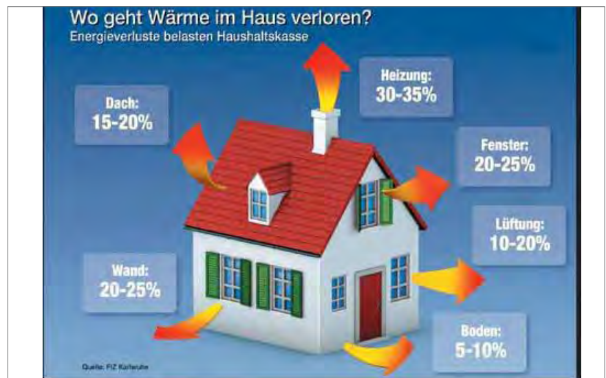
Abb. 149: Durchschnittliche Energie- und Wärmeverluste Altbausubstanz; Quelle: www.energieberatung-mai-feld.info ; 14.10.2010
